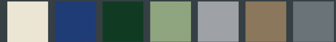
RAL 1013 mat Blanc perlé RAL 5010 mat Bleu gentiane RAL 6005 mat Vert mousse RAL 6021 mat Vert pâle RAL 7004 mat Gris sécurité RAL 7006 mat Gris beige RAL 7012 mat Gris basalte
